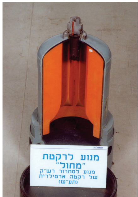
איור 4: מנוע ממטרה רקטי שכוחה בשטח הנהגה לצורך סחרור ראש "מחול"
