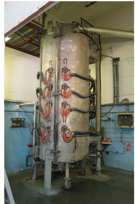
איור 4: מתקן CVD לייצור כיפות ZnS
